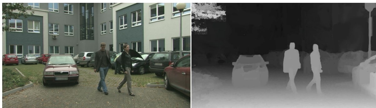
Rys 3. Wybrany widok z sekwencji trójwymiarowej „Poznan Carpark” (po lewej) oraz odpowiadająca mu mapa głębi (po prawej)
