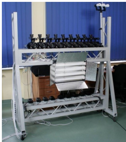
Rys. 5. Części składowe eksperymentalnego systemu wielokamerowego powstałego w Katedrze Telekomunikacji Multimedialnej i Mikroelektroniki z aktywnym udziałem autora rozprawy: statyw wielokamerowy (po lewej) oraz system rejestracji (po prawej)
