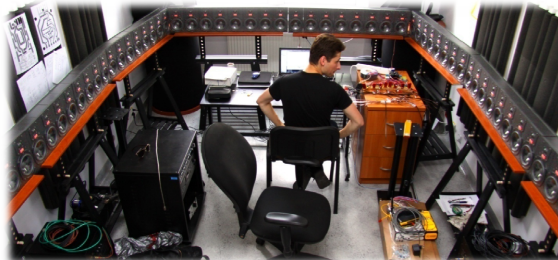
Rys. 2 Eksperymentalny system syntezy pola akustycznego skonstruowany na Politechnice Poznańskiej
