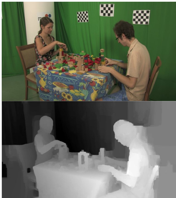
Rys. 3. Kadr pochodzący z zarejestrowanej w studio sekwencji FTV wraz z odpowiadającą mu mapą głębi (Kamera 7)
