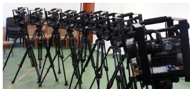
Rys. 2. System kamerowy telewizji swobodnego punktu widzenia (FTV) rozstawiony w studiu
