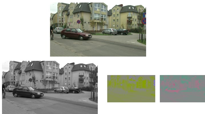
Rysunek 3.1. Reprezentacja obrazu za pomocą 3 składowych w schemacie 4:2:0. Oryginalny obraz kolorowy u góry, na dole – 3 składowe, od lewej: Y, C B oraz C R .
