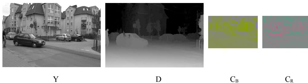
Rysunek 6.3. Pojedyncza ramka jednego widoku w sekwencji wielowidokowej z głębią. Ramka po poddaniu dekompozycji na 4 komponenty: luminancji Y i głębi D o pełnej rozdzielczości oraz zredukowanej rozdzielczości chrominancje C_B i C_R .
